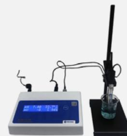
Medidor de pH micro-procesado
