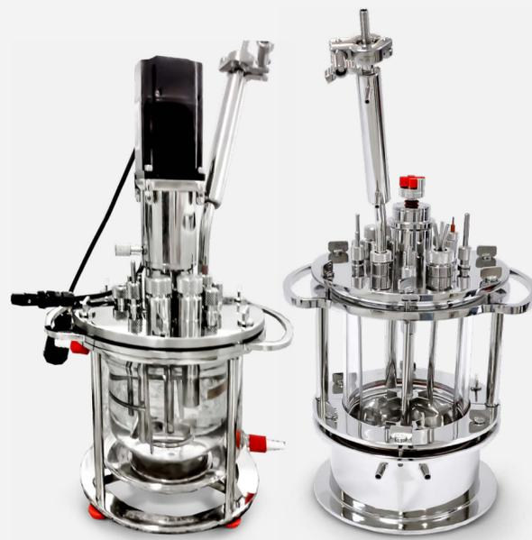
El fluido del baño termostático circula en la camisa del vaso. La temperatura de la reacción depende de la capacidad de calentamiento y enfriamiento del baño.
