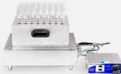
Debido a su alta importancia para la fertilidad del suelo, saber la concentración de nitrógeno es fundamental para una buena recomendación de fertilización. En su método de análisis, es posible utilizar el **TE-040/25** – Bloque digestor tubos micro, además del **TE-0364** – Destilador de nitrógeno/proteína o el **TE-0365/1** – Destilador de nitrógeno con tres pruebas, o, también, el **TE-0366** – Destilador de Nitrógeno Automático.
